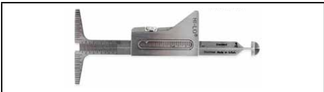
CALIBRADOR DE SOLDADURA - HI/LO Mide el posible desalineamiento de tubos antes y después de ser colocados I137 GAGE
