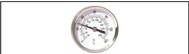
TERMÓMETRO BIMETÁLICO Rango de 0 a 150 °C con carátula de 3", Conexión posterior de 1/2" y vástago de 150mm I141
